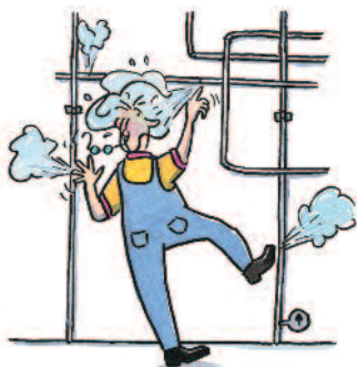
Kostspielige Druckluft-Leckagen an Rohrleitungen, Verbindungsstellen, Schläuchen, Kupplungen und Reglern abdichten.
