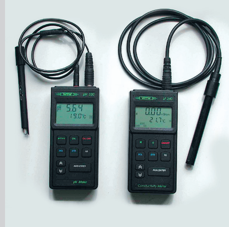
El sistema de control de la solución de mojado incluye un conductímetro digital, un pHmetro y un termómetro con sensor (los dispositivos digitales son más exactos y fáciles de calibrar), un densímetro para comprobar el porcentaje de alcohol y un comprobador de la dureza del agua. Foto: Sun Chemical.
