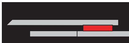
Collage à chevauchement normal avec queue.
