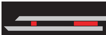
Queue de collage maintenue par un ruban adhésif étroit.
