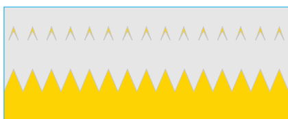
Rebondissement de lame ou tension trop élevée
