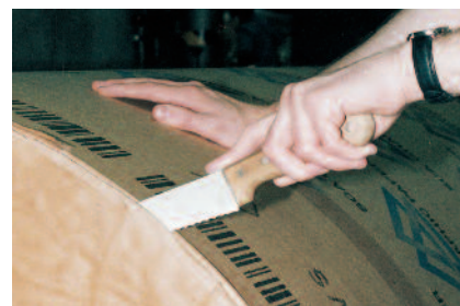
Oter les flasques à l'aide d'un couteau à large lame.
