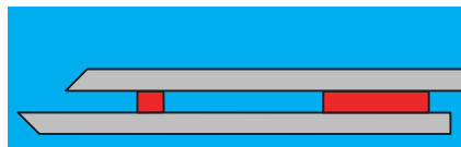
Хвост бумажной ленты сзади места склейки зафиксирован узкой полоской самоклеящейся ленты
