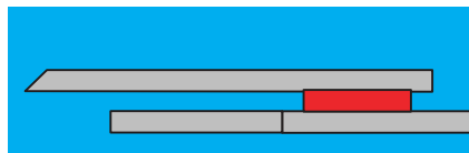
Хвост при стандартной склейке бумажных лент внахлёт
