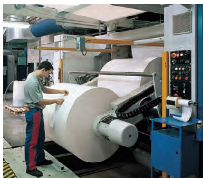
Подготовка места склейки на рулоне в устройстве склейки
