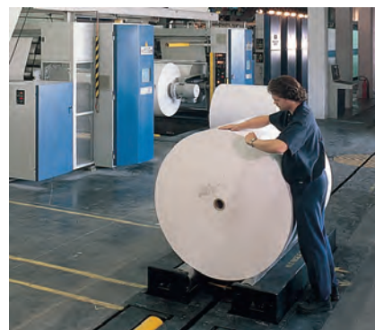
Подготовка места склейки на рулоне вне устройства склейки
